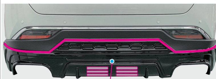
バンパー裏面より付属 b、cを使用して固定
